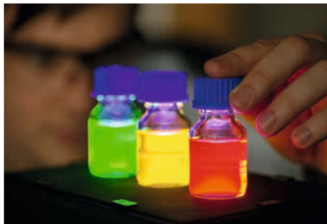
Abb. 2: Optisch (blaue LED) angeregte Quantenpunkt-dispersionen mit verschiedenen Emissionsfarben
